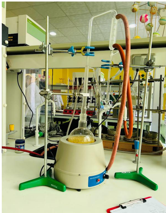
Figure 20: extraction par hydro distillation d'HE de Citrus limon (photo prise le 19 avril 2022).
